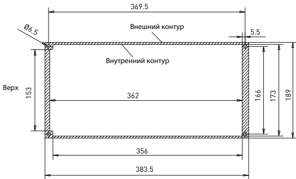
Рис. 5: Размеры выреза для фланцевого крепления приводов типоразмеров M14 (единица: мм)
