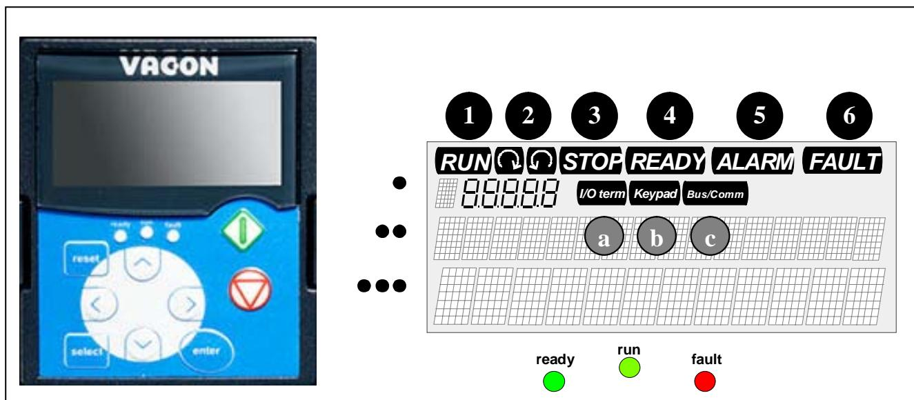
Рисунок 9-1. Панель управления преобразователя частоты Vacon NX и индикаторы состояния привода
