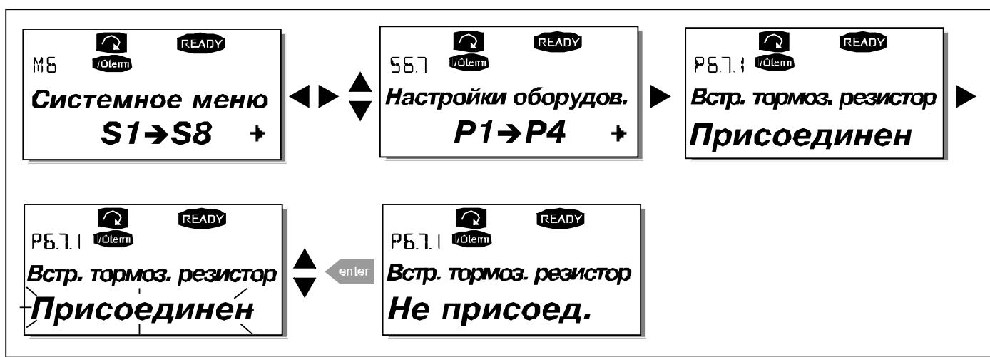
Рисунок 9-21. Подключение встроенного тормозного резистора
