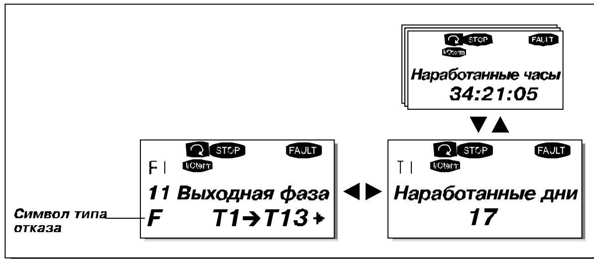
Рисунок 9-7. Отображение отказов на дисплее
