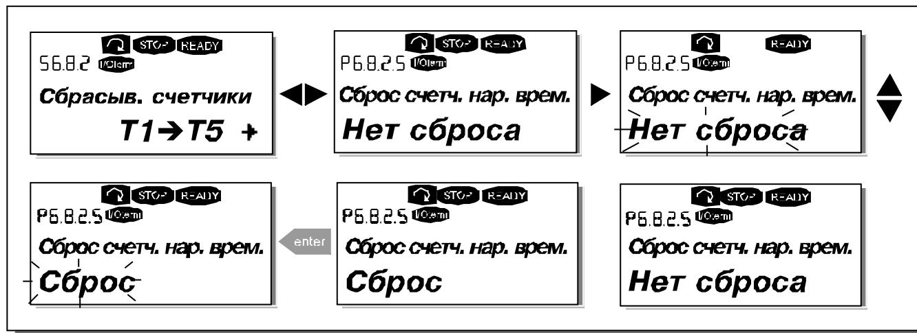
Рисунок 9-24. Сброс счетчиков
