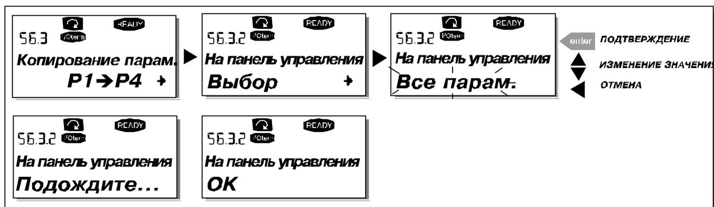
Рисунок 9-12. Копирование параметров в панель управления
