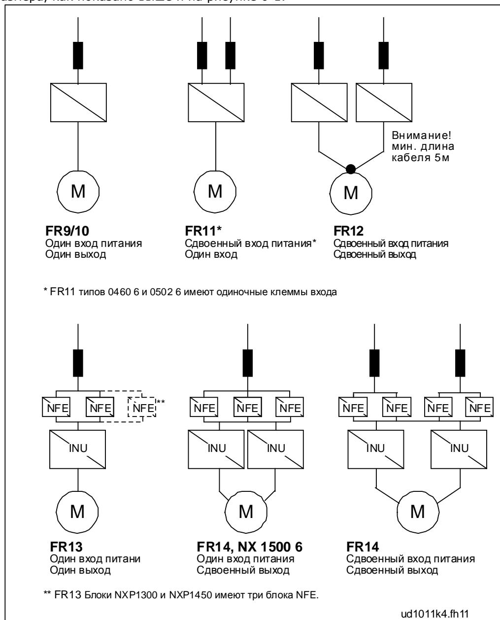
Рисунок 6-1. Схема типоразмеров FR9 – FR14, 6/12-пульсное питание
