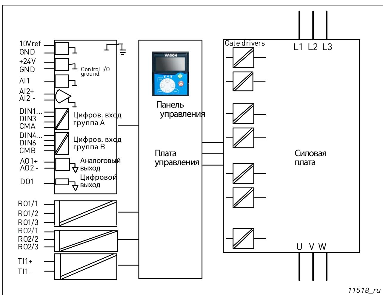
Рисунок 8-6. Гальваническая развязка
