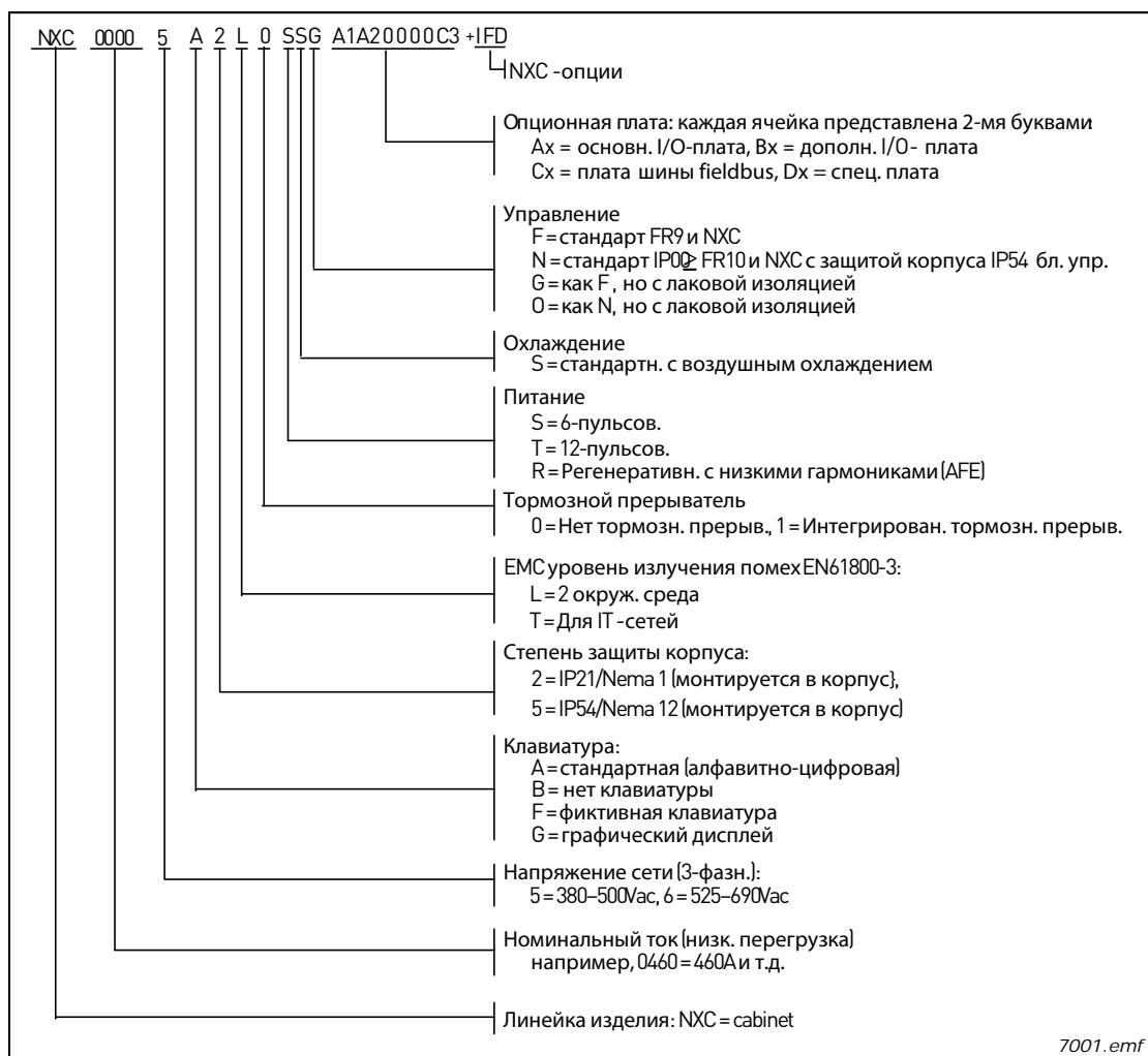
Рисунок 3-1. Код преобразователя частоты Vacon NX
