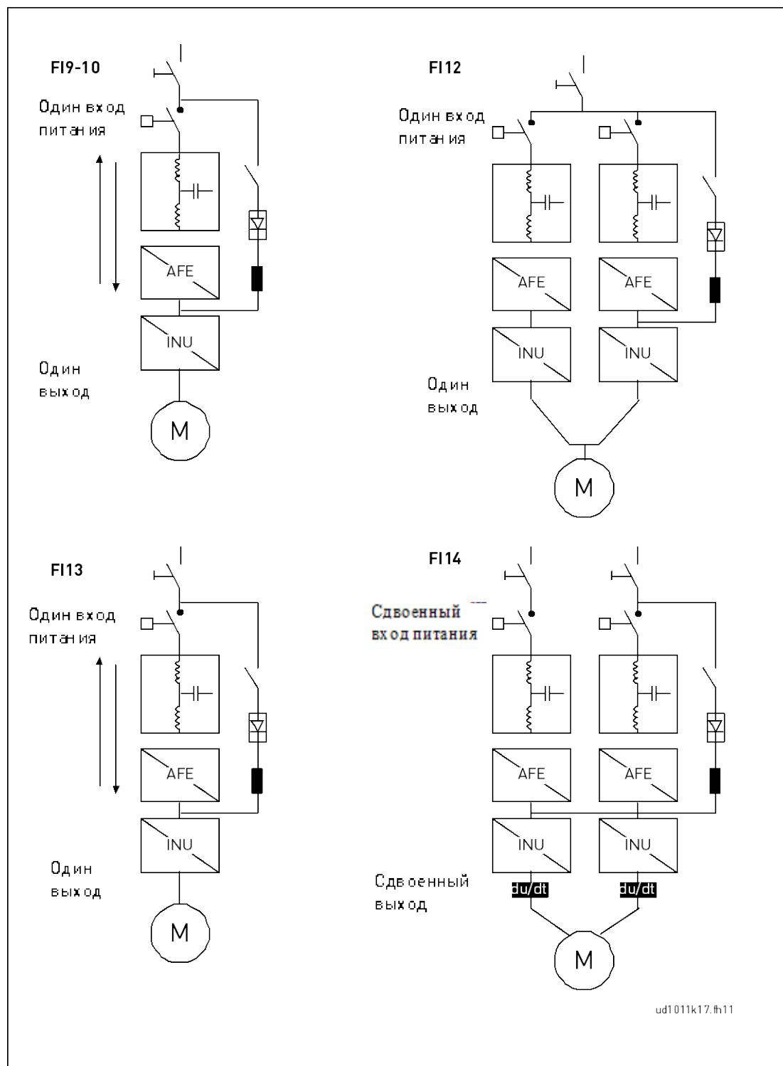
Рисунок 6-2. Схема типоразмеров FR9 – FR14, NXC регенеративные, с низкими гармониками
