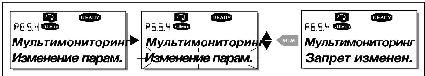
Рисунок 9-17. Разрешение на замену трех контролируемых параметров
