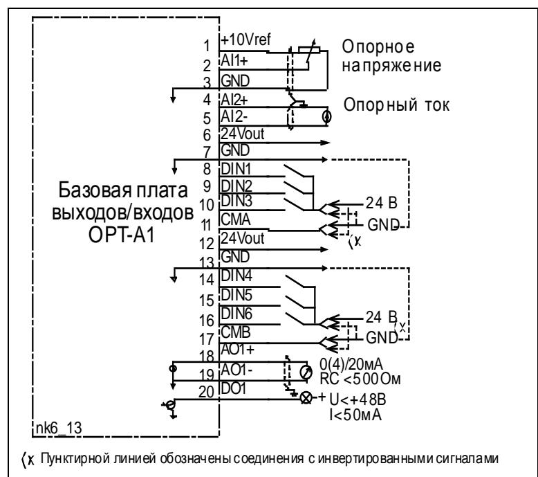
Рисунок 8-4. Принципиальная схема подсоединения базовой платы входов/выходов (OPT-A1)
