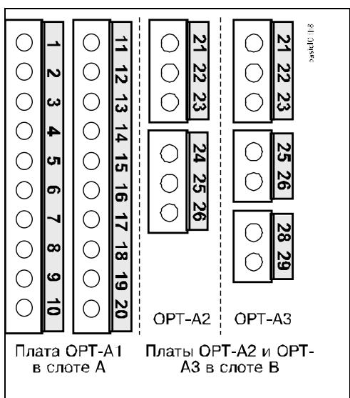
Рисунок 8-3. Клеммы входов/выходов базовых плат
