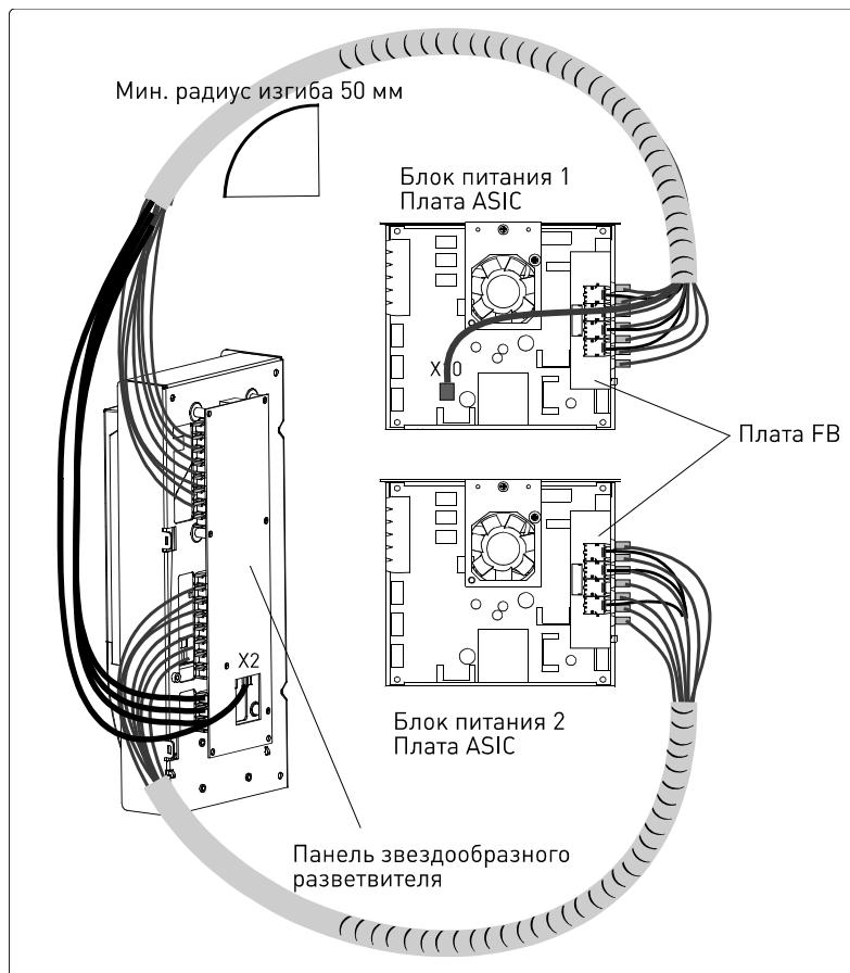
Рисунок 8-10. Подключение кабелей питания и управления к блоку управления, FR12
