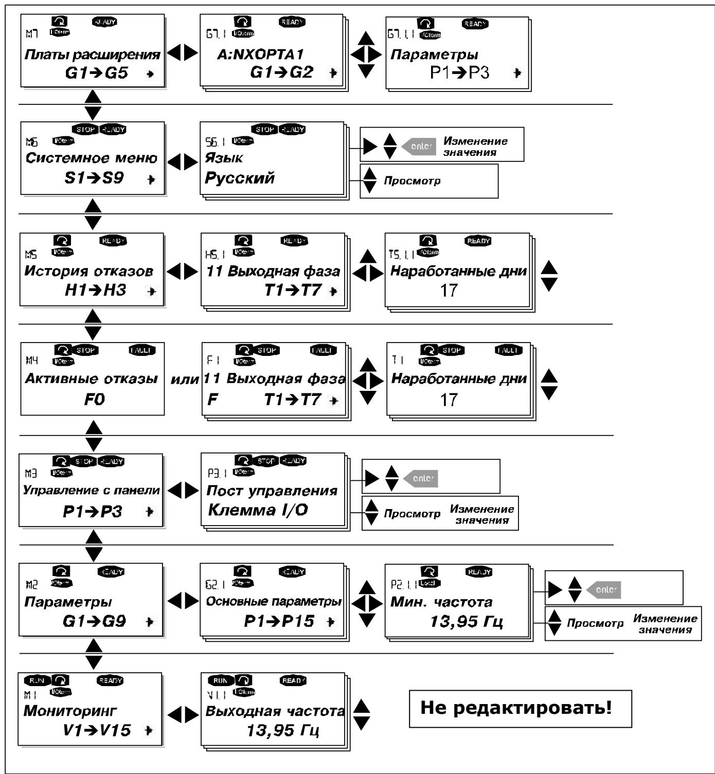
Рисунок 9-3. Схема навигации по меню панели управления
