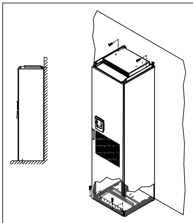
Рисунок 5-3. Крепление шкафа к полу и стене
