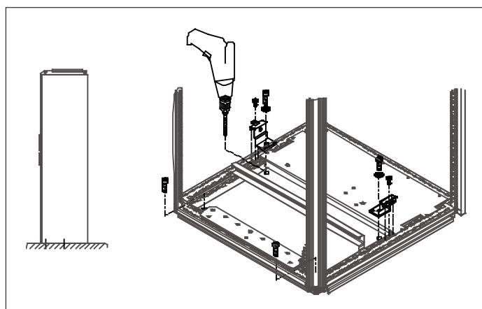
Рисунок 5-4. Крепление всех четырех углов к полу
